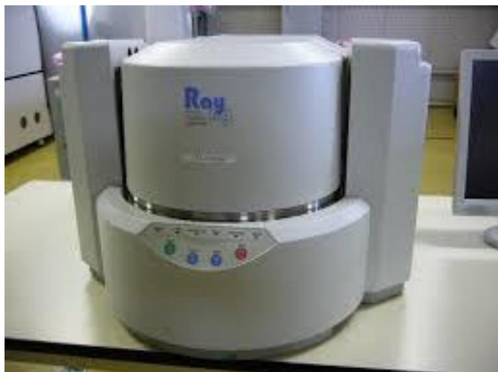
Figura 3.5 – Equipamento EDX-720 para ensaio de FRX
