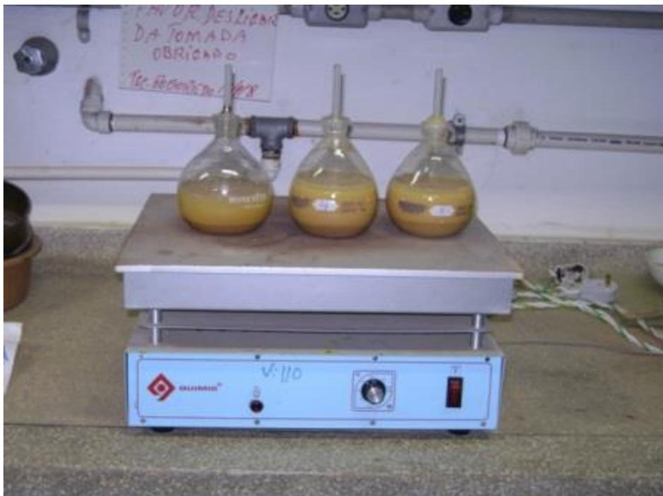
Figura 3.6 – Ensaio de massa específica dos sólidos
