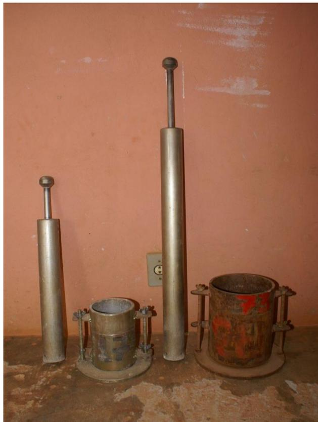
Figura 3.11 – Ensaio de Compactação
