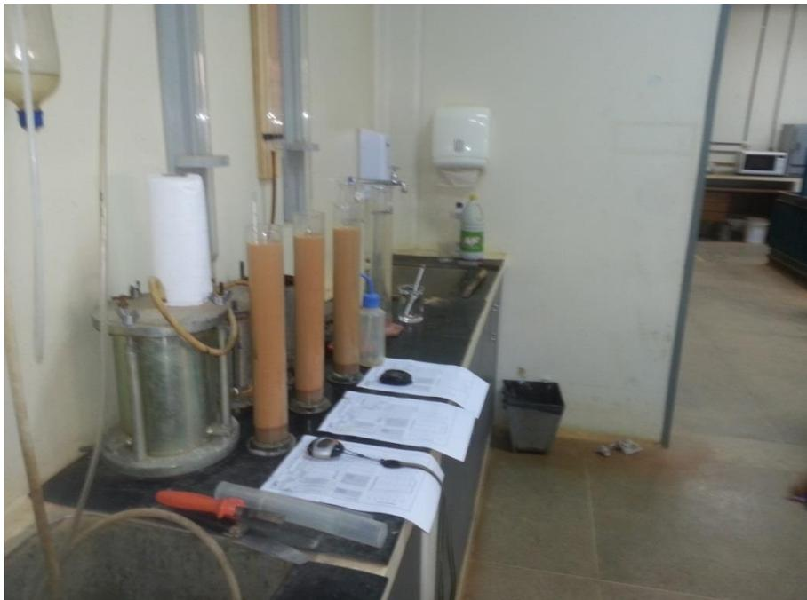
Figura 3.8 – Granulometria por Sedimentação
