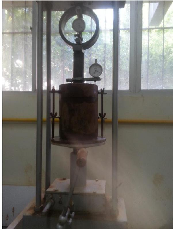
Figura 3.12 – Ensaio do Índice de Suporte Califórnia
