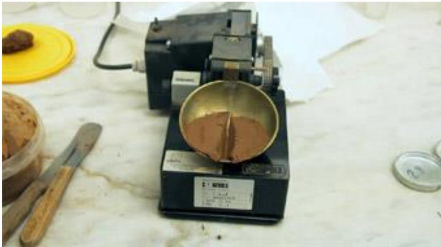
Figura 3.9 – Determinação do limite de liquidez
