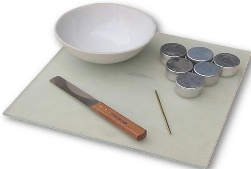
Figura 3.10 – Determinação do limite de plasticidade
