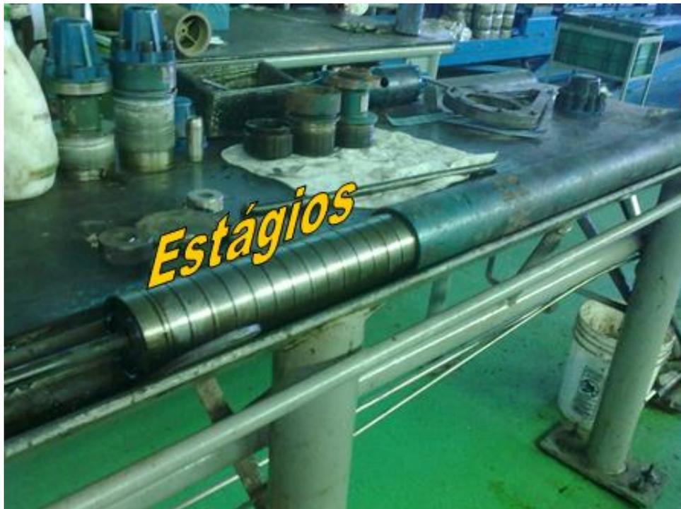
Figura 11 – Estágios de uma Bomba Centrífuga (Sales, 2012)
