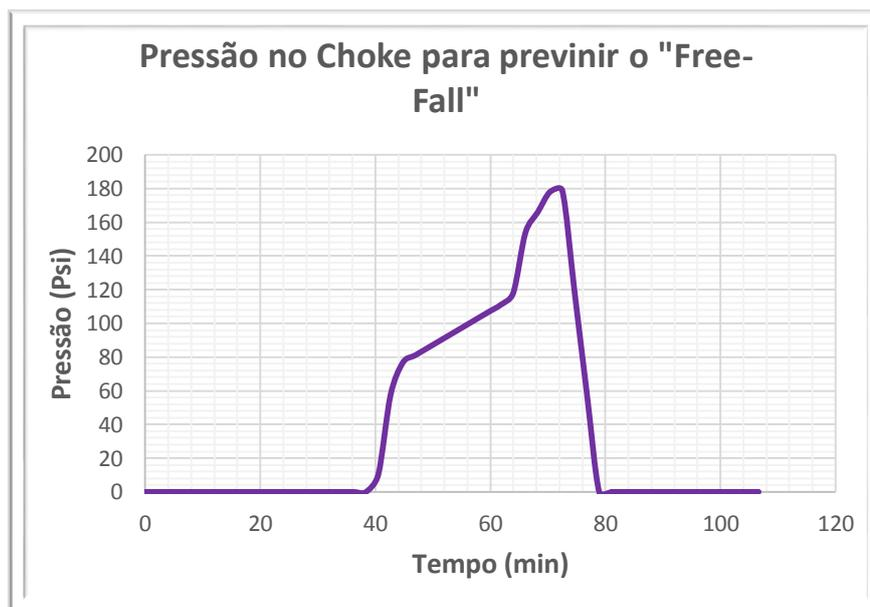
Figura 8: Exemplo de gráfico da pressão no *choke* necessária para evitar o *Free Fall*.
