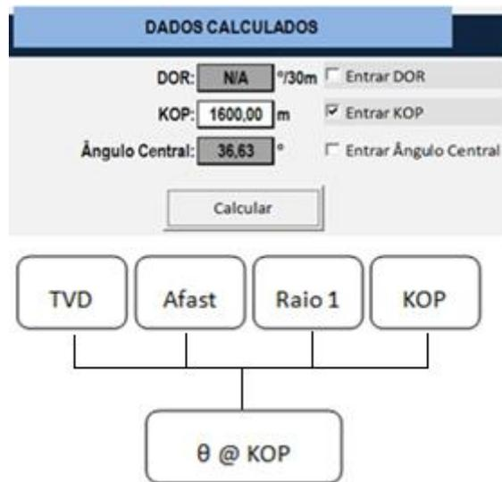
Figura 11. Fluxograma da rotina para poços do tipo I com entrada do valor do KOP.
