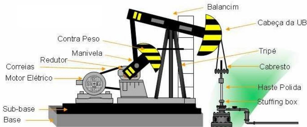
Figura 2 – Equipamentos de superfície (THOMAS et al, 2004).
