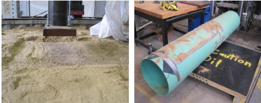
Figura 2.14 – Foto do ensaio de placa e inspeção visual (KRAUS et al. 2013).
