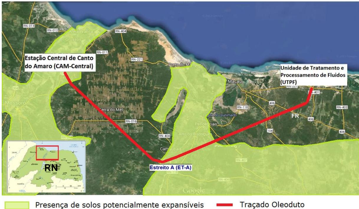
Figura 3.10 – Mapeamento dos solos potencialmente expansivos na região de estudo (Adaptado de PEREIRA et al. 2004).
