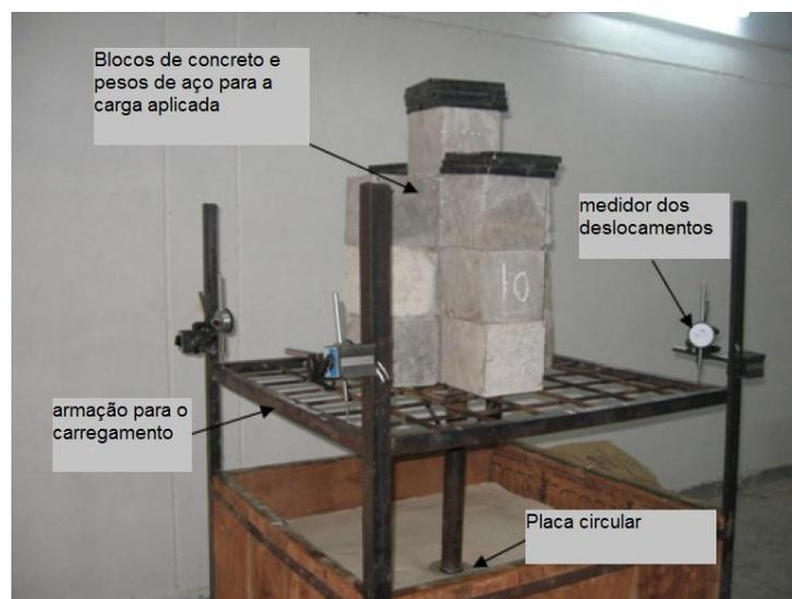
Figura 2.12 – Instrumental usado pelo modelo físico (SRIVASTAVA et al. 2012).
