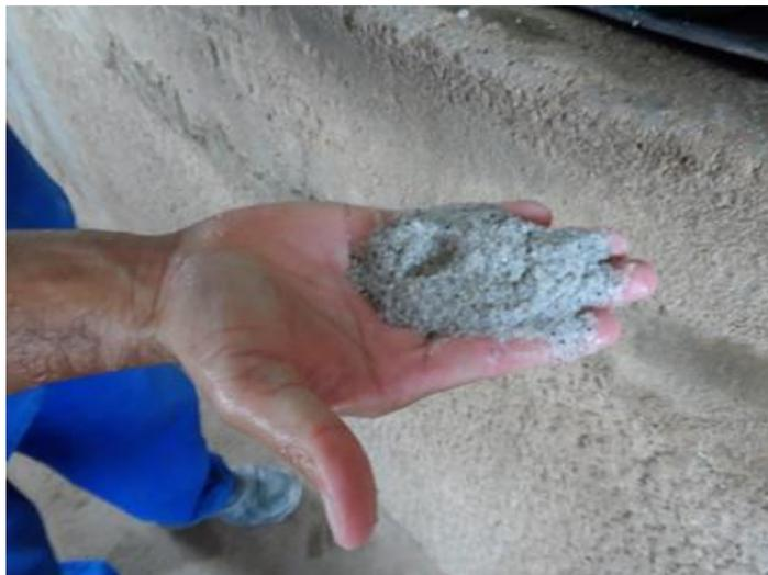
Figura 2.16- Scheelita coletada abaixo do jigue (granulado)
