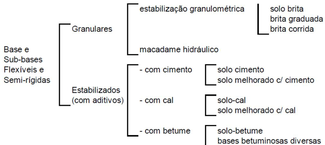
Figura 2.29 - Tipos de bases e sub-bases
