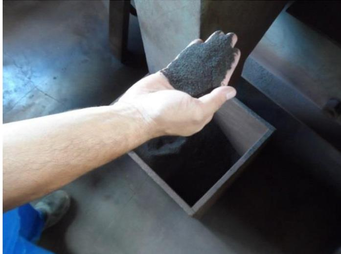
Figura 2.22- Impurezas da scheelita
