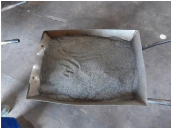
Figura 2.21- Scheelita queimada em direção ao eletroímã
