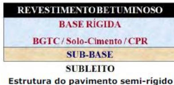
Figura 2.27- O pavimento semi-rígido
