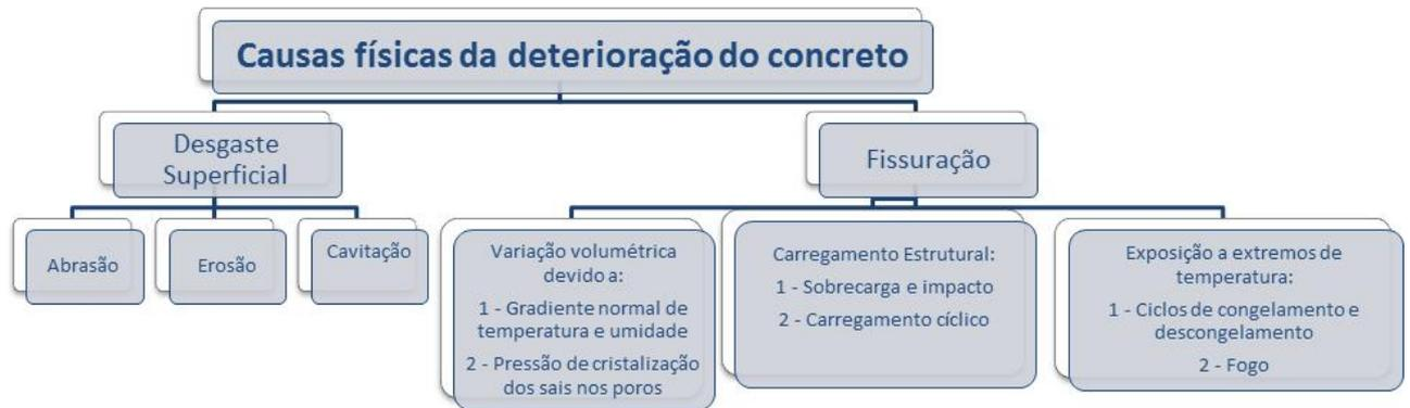
Figura 2-4 - Causas básicas da deterioração do concreto. Fonte: (MEHTA, 2005) – Adaptada
