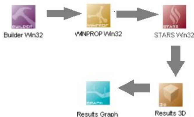
Figura 3-1: Fluxograma dos programas utilizados.
