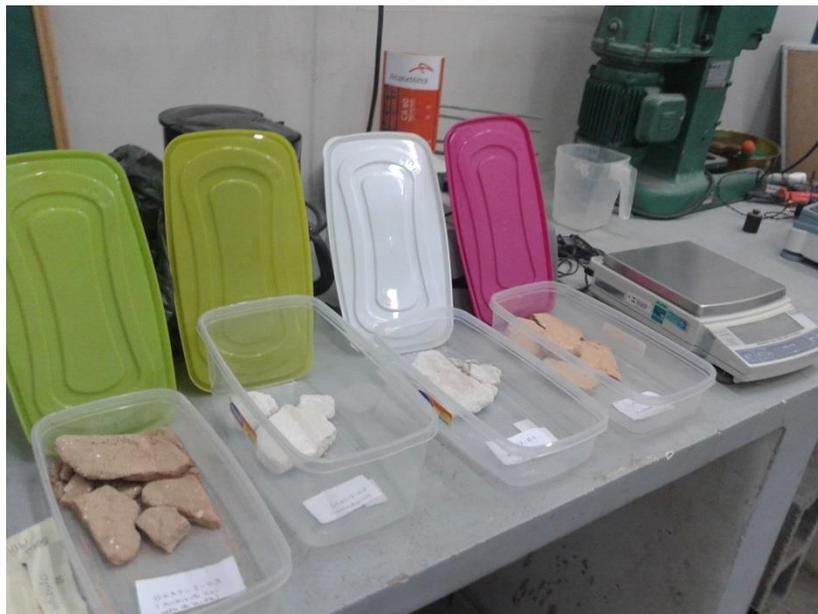
Figura 3.15: Pesagem e armazenamento das amostras da argamassa de revestimento do GEAS.
