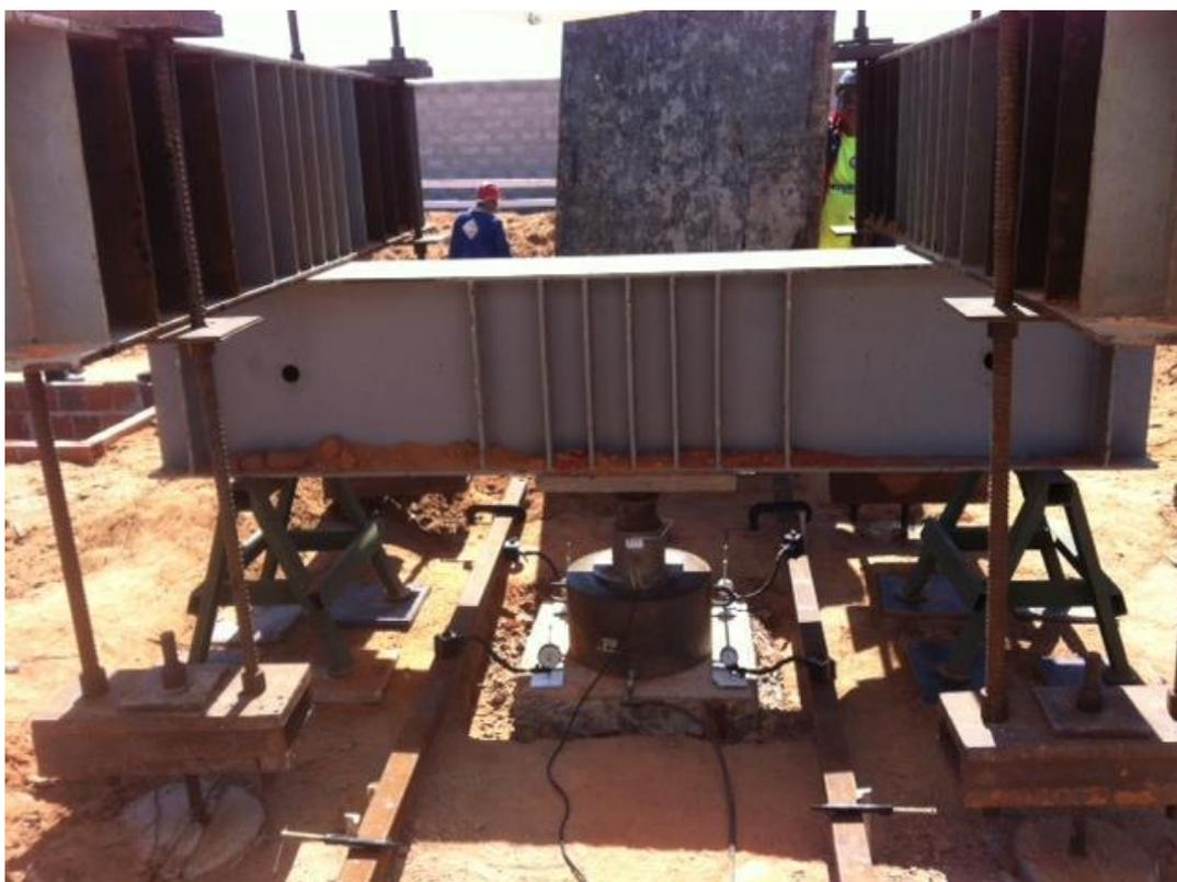
**Figura 2-11** Foto ilustrativa de uma situação real de aplicação de prova de carga.
