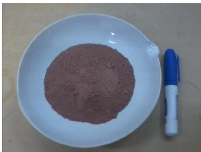
Figura 5.7 - CLE após moagem e peneiramento
