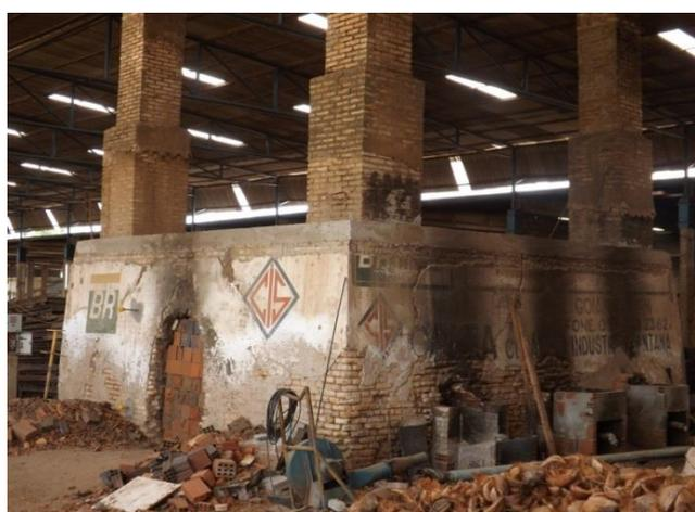
Figura 5.4 - Forno onde foi incinerado o lodo
