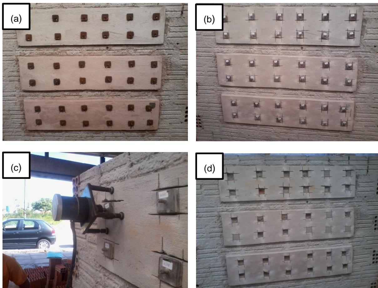
Figura 5.15 - Determinação da resistência de aderência à tração (a) colagem das placas metálicas quadradas (b) corte das pastilhas metálicas (c) acoplamento do aparelho de tração (d) faixas de argamassa após ensaio.
