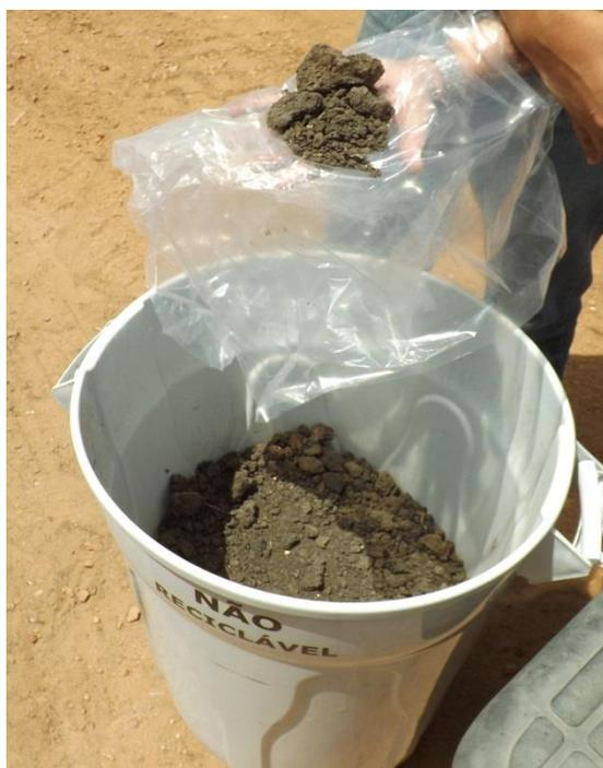
Figura 5.3 - Lodo parcialmente seco
