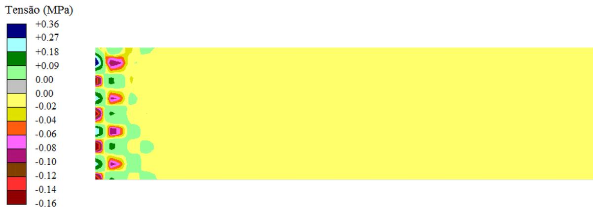
Figura 6.23. – Tensões na direção “y” aos 8000 dias com a RAA para o caso 3
