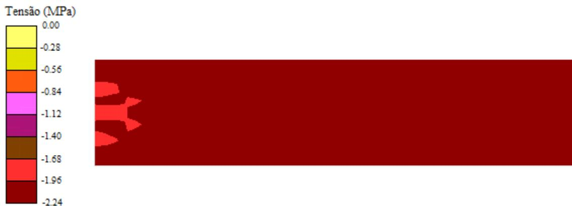
Figura 6.7. – Tensões na direção "x" imediatas ao carregamento para o caso 7
