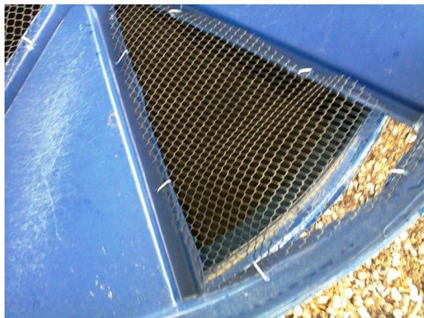
Figura 3: Telas nas tampas para facilitar a manutenção diária. Fonte: Autor (2013)
