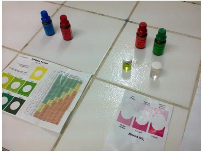
Figura 25: Kits da indústria LABCON (pH tropical, amônia tóxica, dureza em carbonatos KH.
