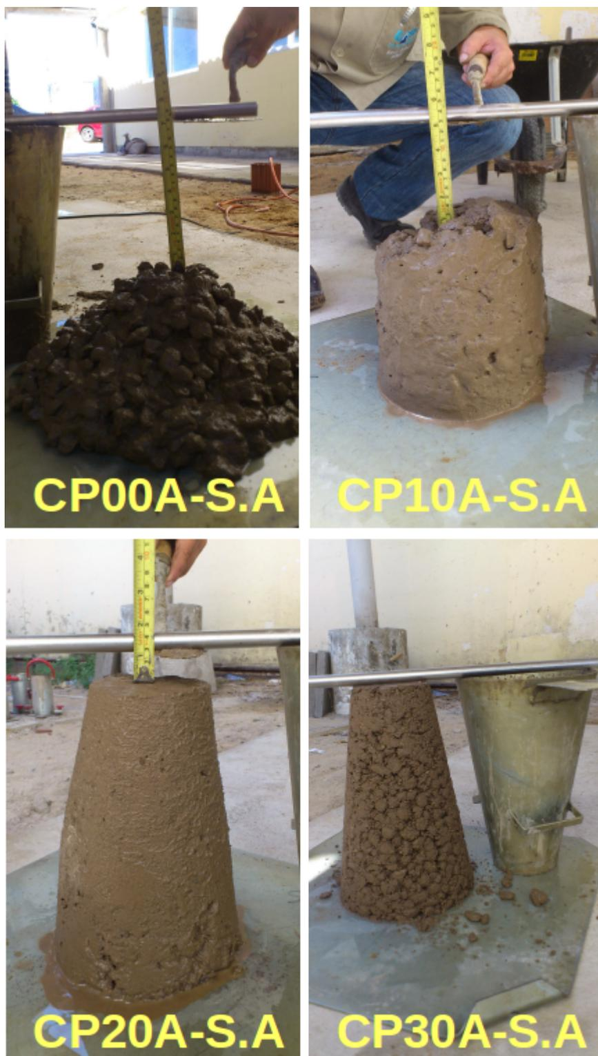
Figura 4.12: Aspecto visual dos concretos com e sem adição de CLS
