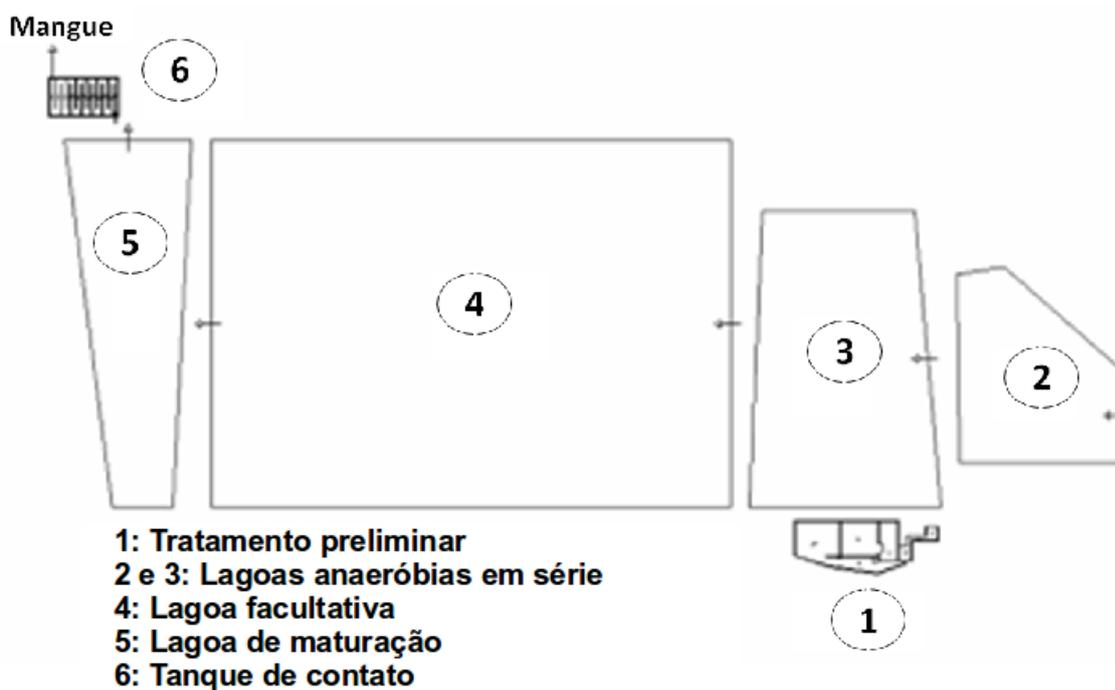
Figura 3.1: Croqui do sistema de tratamento da Imunizadora Potiguar
