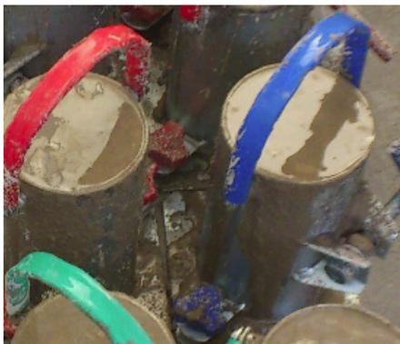
**Figura 4.13:** Exsudação nos CP's do concreto CP00A-S.A
