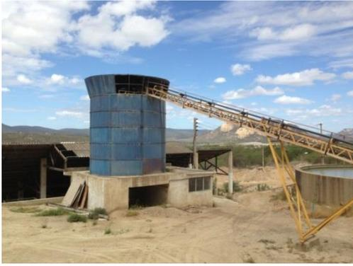
Figura 2.8 – Depósito após britadores.
