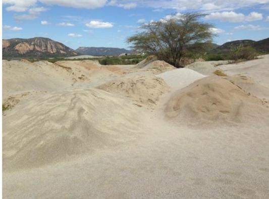
Figura 2.22 – Dunas de resíduos da extração da Scheelita.
