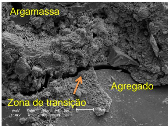
Figura 4.24 – Zona de transição entre agregado e argamassa do TR20%.
