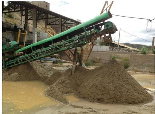
Figura 2.21 – Resíduo da extração da Scheelita.
