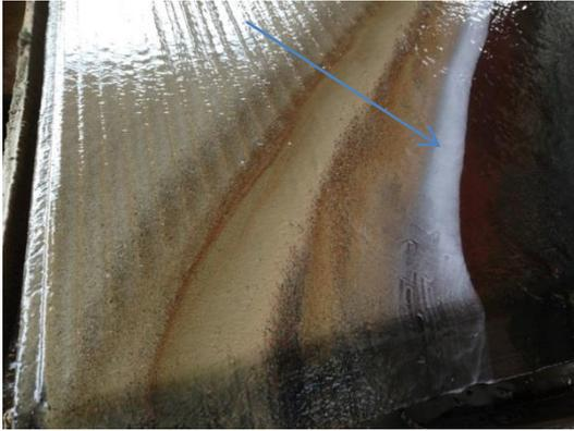
Figura 2.18 – Detalhe da Scheelita nas mesas vibratórias.
