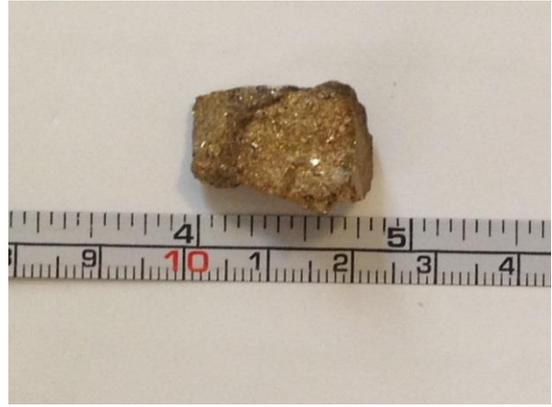
Figura 3.11 – Amostra de concreto metalizada
