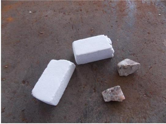
Figura 3.10 – Fratura das Amostras de concreto.
