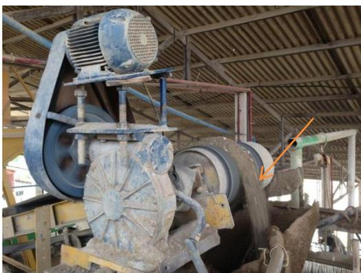
Figura 2.12 – Material caindo em um depósito e sendo hidratado.
