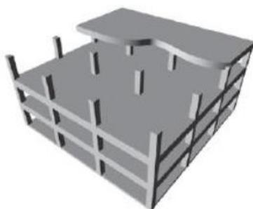
Figura 3.16 - Sistema de Pórticos Resistentes (FEMA 454 :2007)
