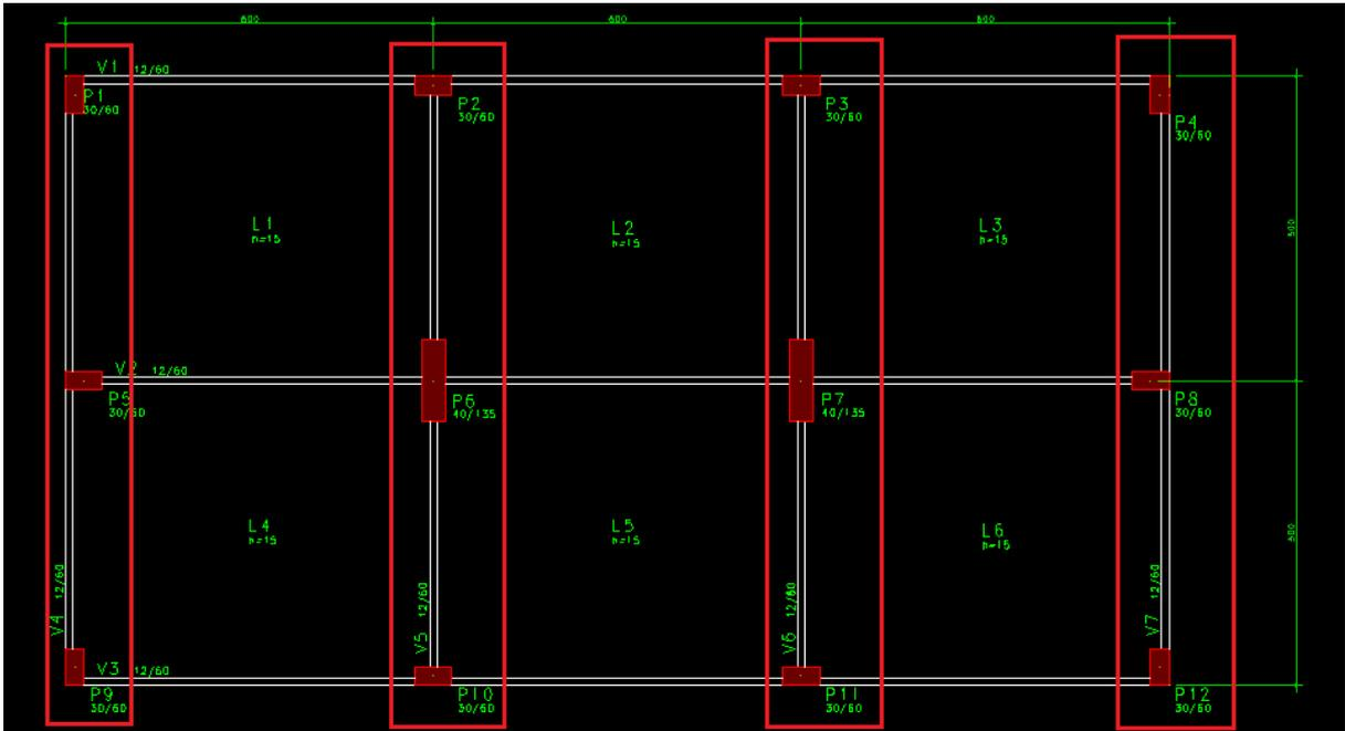
Figura 5.4 – Detalhamento dos pórticos resistentes segundo o plano Y
