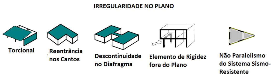
Figura 3.41 – Resumo dos tipos de irregularidades no plano horizontal (adaptada da norma colombiana NSR-10).
