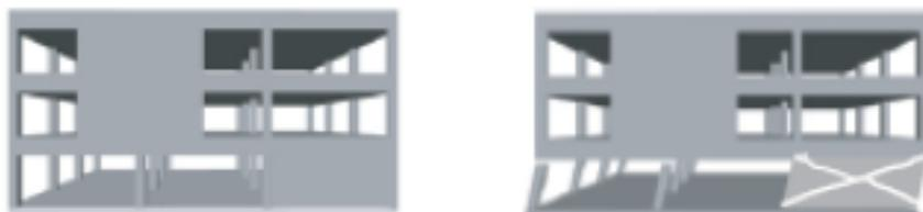
Figura 3.54 - Representação de irregularidades no plano vertical resistente (FEMA 454:2007)
