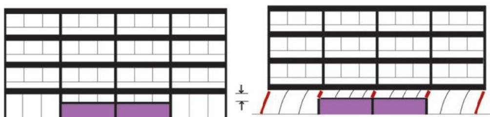
Figura 6.8 - Geração do mecanismo de ruína devido ao efeito da coluna curta nas regiões centrais devido a descontinuidade dos painéis de alvenaria (FEMA 454 :2007)
