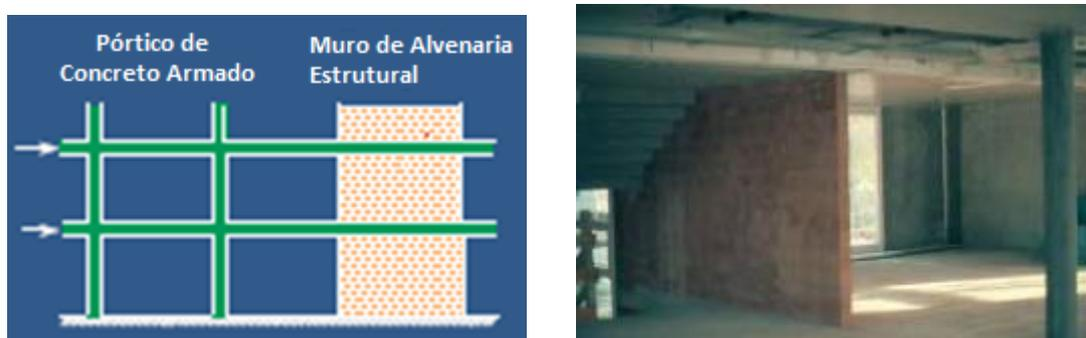
Figura 3.23 - Sistema sismo-resistentes em Concreto Armado e Alvenaria Estrutural (BACHMANN:2003)
