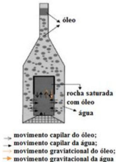
**Figura 7.** Esquema representativo dos mecanismos de embebição. Fonte: adaptado de Babadagli (2002).
