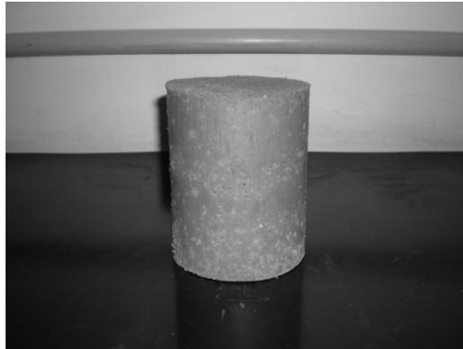
Figura 3.9 – Corpo de prova do solo natural (Ensaio de compactação).
