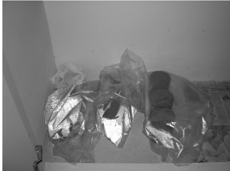
Figura 3.10 – Corpos de prova armazenados em sacos para a cura úmida.
