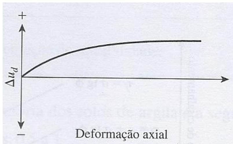
Figura 3.13– Comportamento esperado da variação da poropressão com a deformação axial para areia fofa e argila normalmente adensada. (Das, 2007)
