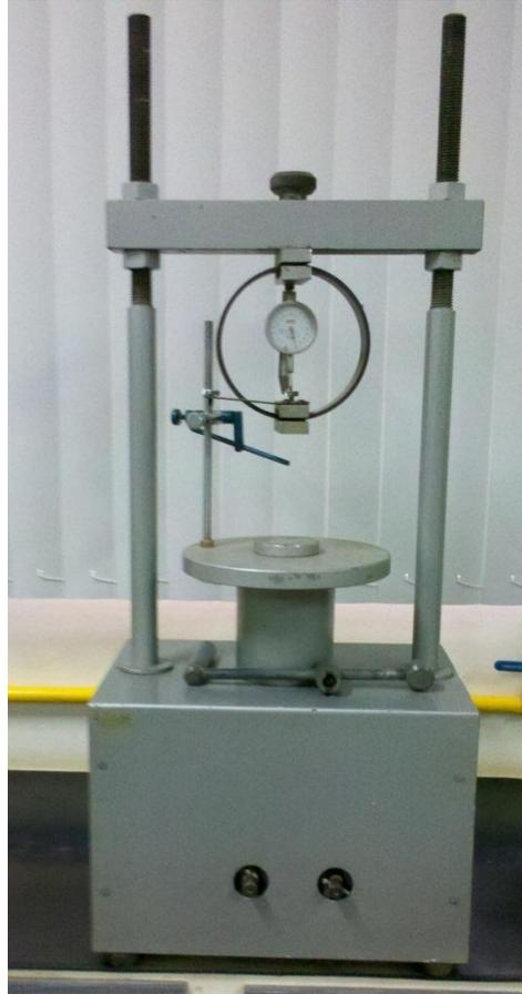
Figura 3.7– Prensa utilizada na compressão simples.
