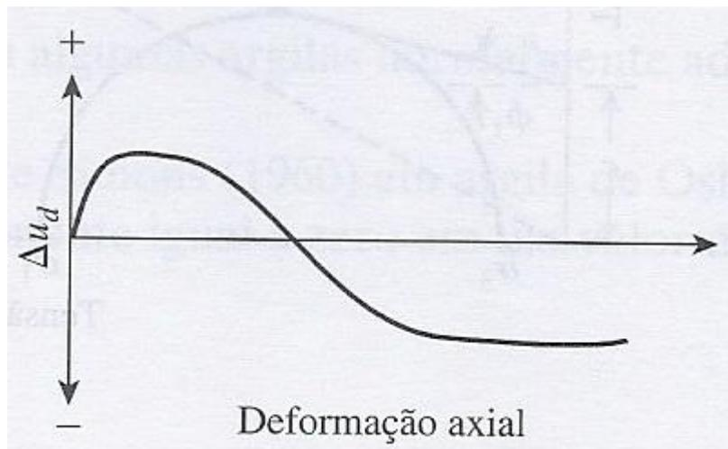
Figura 3.14– Comportamento esperado da variação da poropressão com a deformação axial para areia compacta e argila sobreadensada. (Das, 2007)
