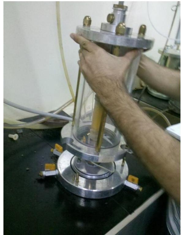
Figura 3.19– vedação da câmara triaxial.
