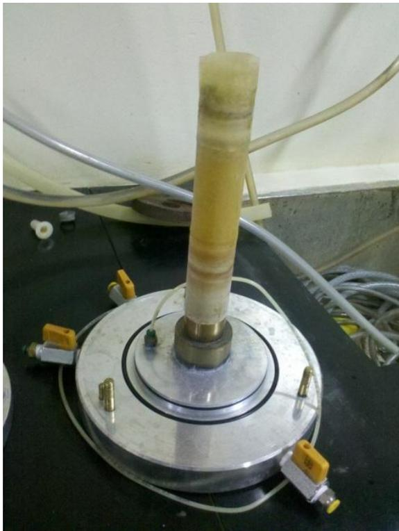
Figura 3.18– Corpo de prova envolto na membrana de látex.
