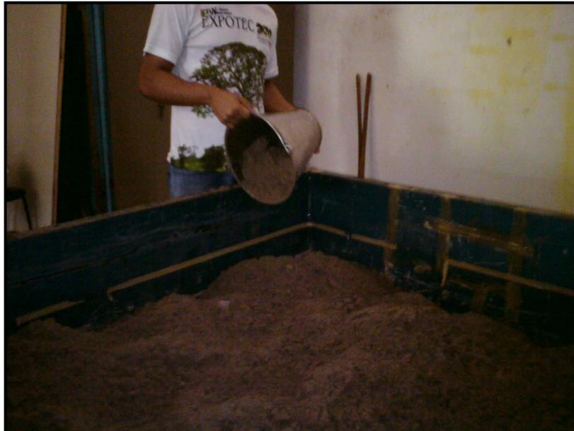
Figura 3.14 Lançamento do solo dentro da caixa de ensaios.
