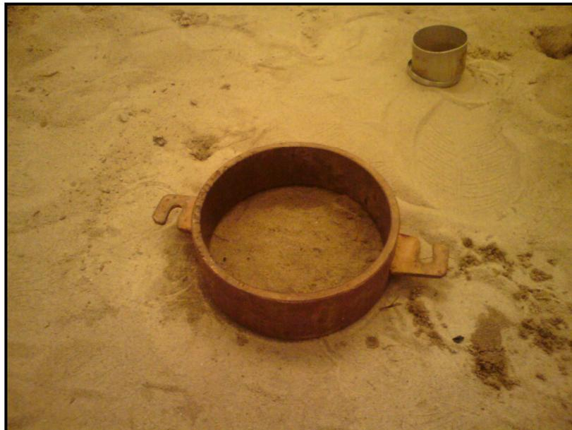
Figura 3.22 Detalhe do colar do cilindro grande de Proctor utilizado para limitar a área para colocação da água.
