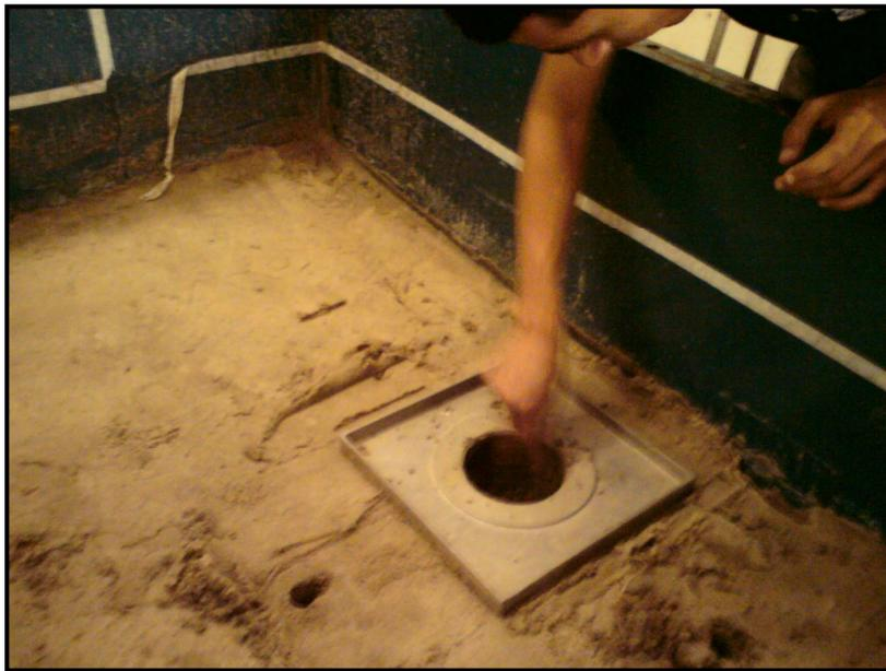
Figura 3.15 Execução do ensaio de frasco de areia.
