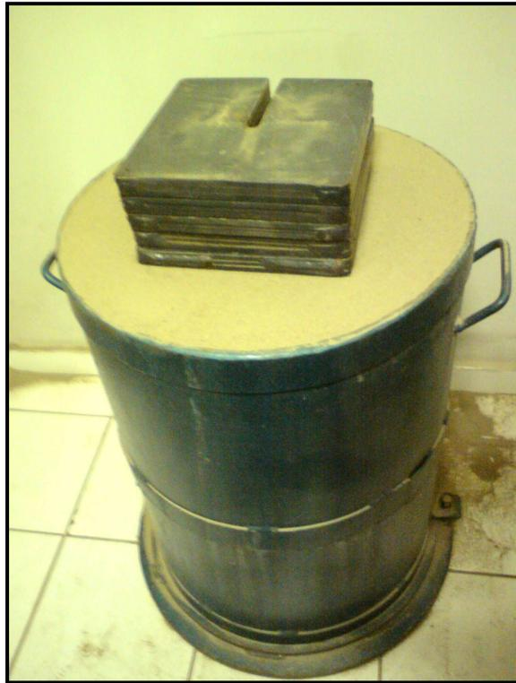
Figura 3.10 Cilindro preenchido de areia e com a sobrecarga.
