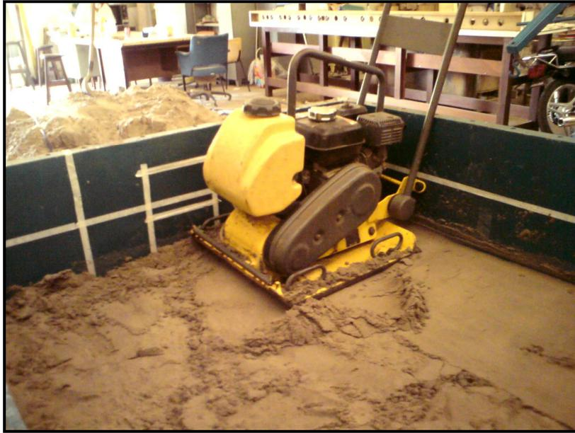
Figura 3.12 Compactação do solo dentro da caixa.
