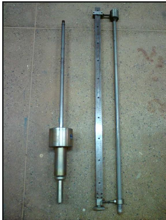
Figura 3.1 Penetrômetro dinâmico de cone.
