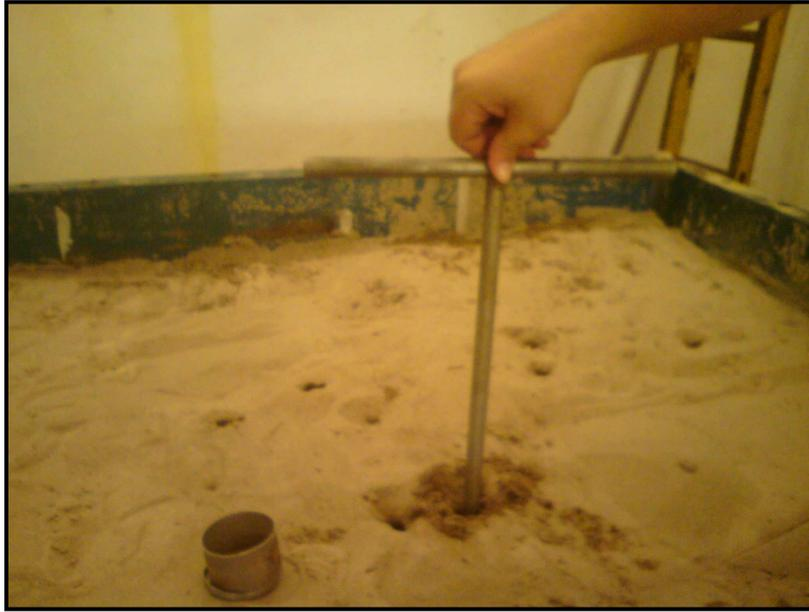
Figura 3.17 Coleta da amostra para determinação do teor de umidade.
