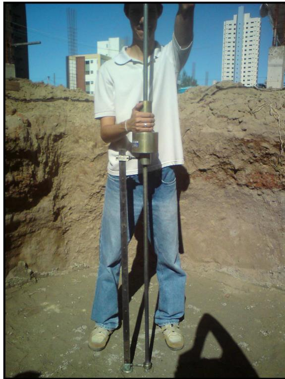
Figura 2.2 Realização do ensaio DCP.
