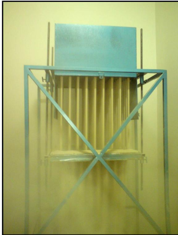
Figura 3.8 Equipamento da chuva de areia em funcionamento.
