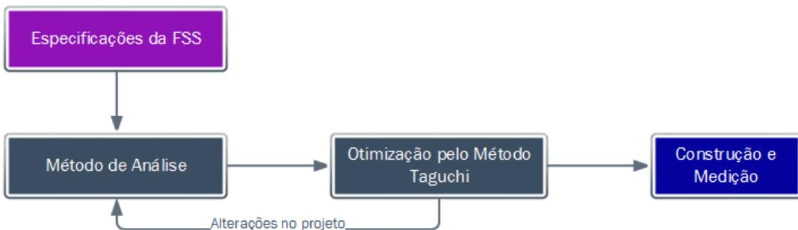
Figura 5.2 - Projeto de uma estrutura FSS com a otimização do método Taguchi.
