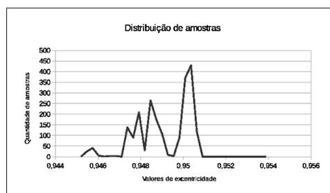
Figura A.16: Distribuição da excentricidade da luminária com espelhamento
