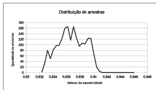
Figura A.20: Distribuição da excentricidade da luminária com 4 lâmpadas
