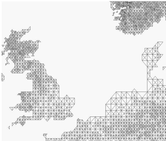
Figura 2.7: Ilustração de uma triangulação 2D obtida usando uma técnica de triangulação retangular adaptativa.
